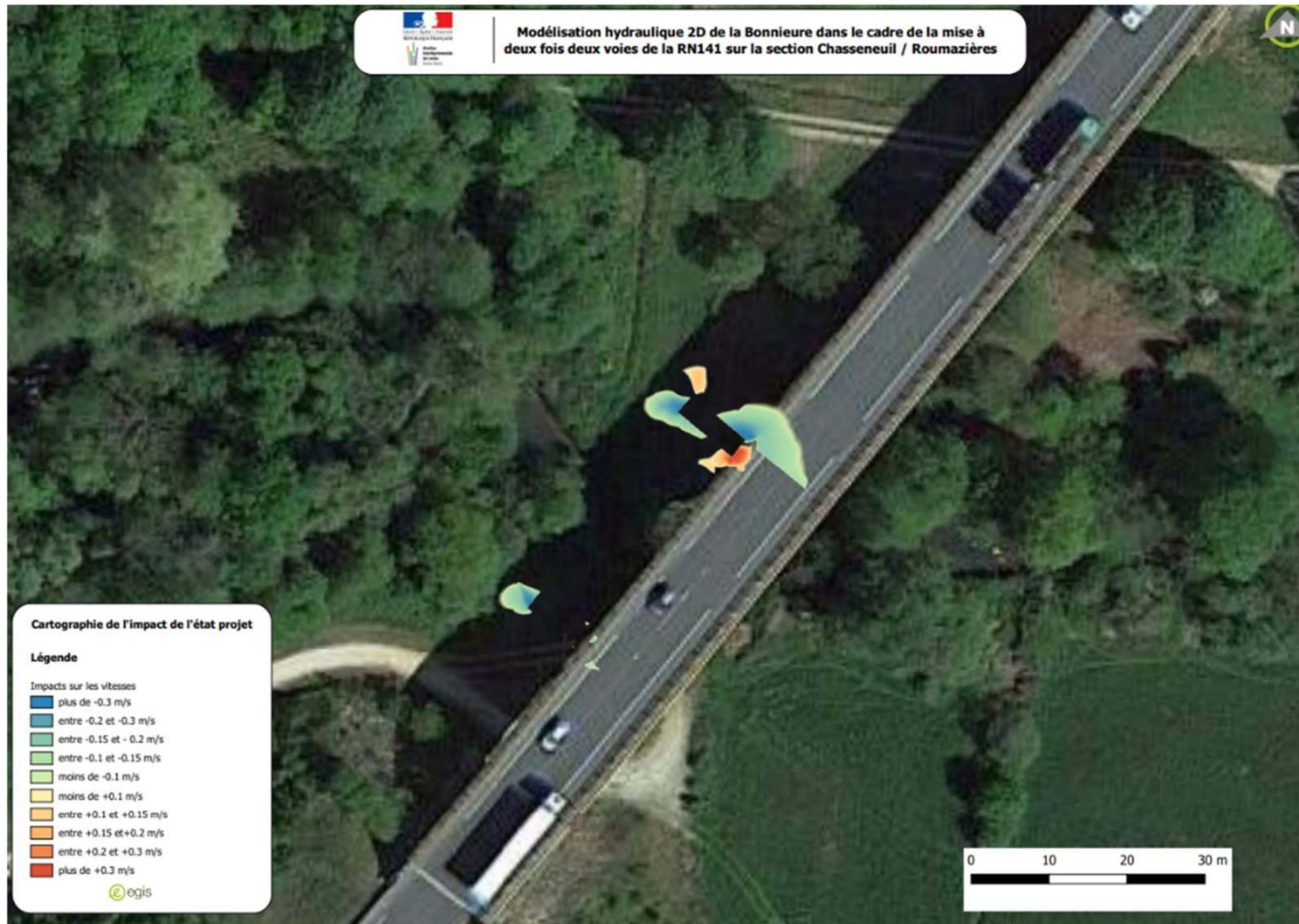
FIGURE 12 : IMPACT SUR LES VITESSES DU DOUBLAGE DU VIADUC SUR LA N141 POUR UNE CRUE CENTENNALE
