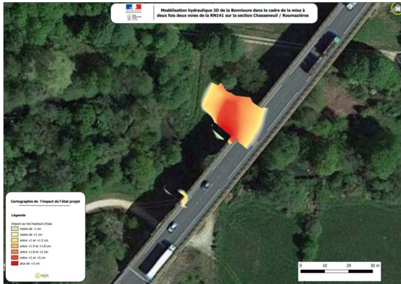
FIGURE 37 : IMPACT SUR LES HAUTEURS D'EAU DU DOUBLAGE DU VIADUC SUR LA RN141 POUR UNE CRUE CENTENNALE Le projet a un impact très localisé au niveau des piles de pont. Le doublage des piles engendre une augmentation légère des hauteurs d'eau au niveau des piles de pont les plus proches du cours d'eau. L'impact maximum est de l'ordre de +2/3 cm sur la pile en rive droite du cours d'eau.
