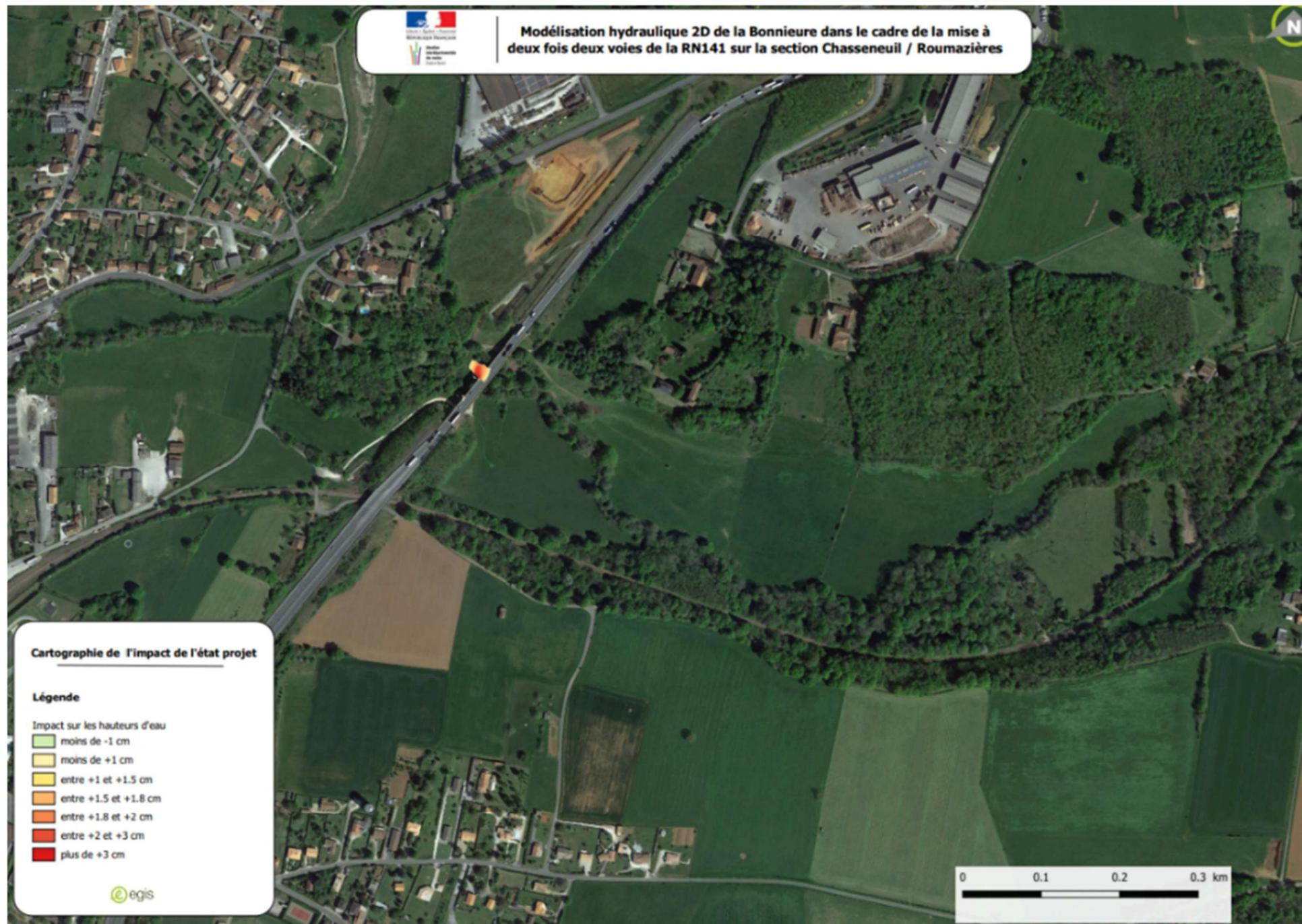
FIGURE 10 : IMPACT SUR LES HAUTEURS D'EAU DU DOUBLAGE DU VIADUC SUR LA N141 POUR UNE CRUE CENTENNALE
